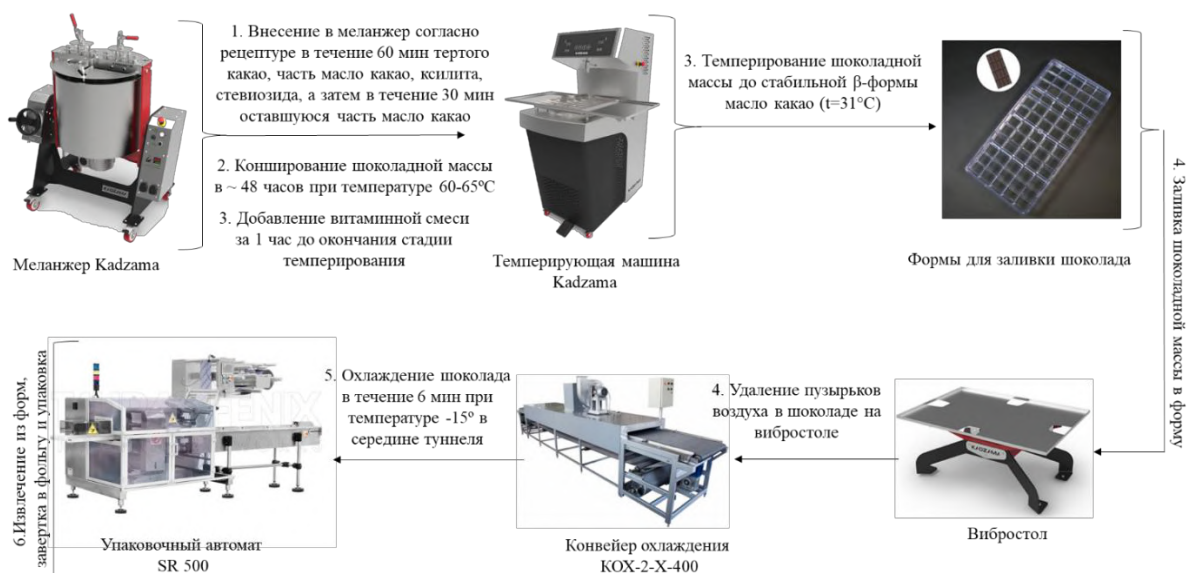
Рисунок 4.1 – Общая схема производства горького шоколада
