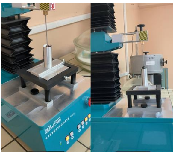
Рисунок 4.2 – Погружение индентора «Шарик Ø15» в цилиндр с шоколадной массой на Структурометре СТ-2
