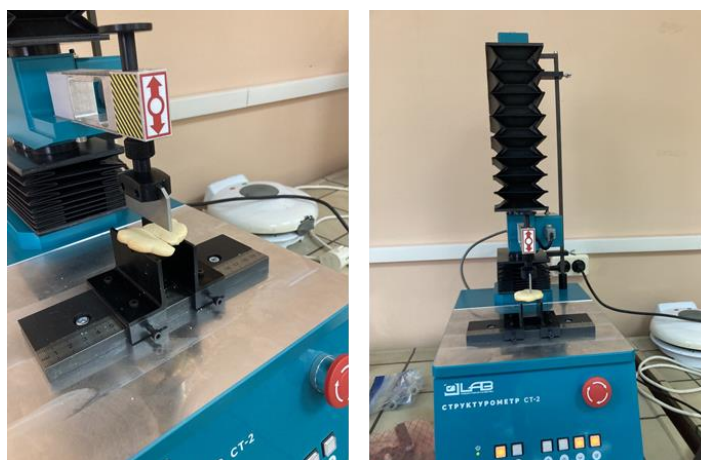
Рисунок 4.8 – Процесс работы Структурометра СТ-2 с установленным индентором «Пластина»
