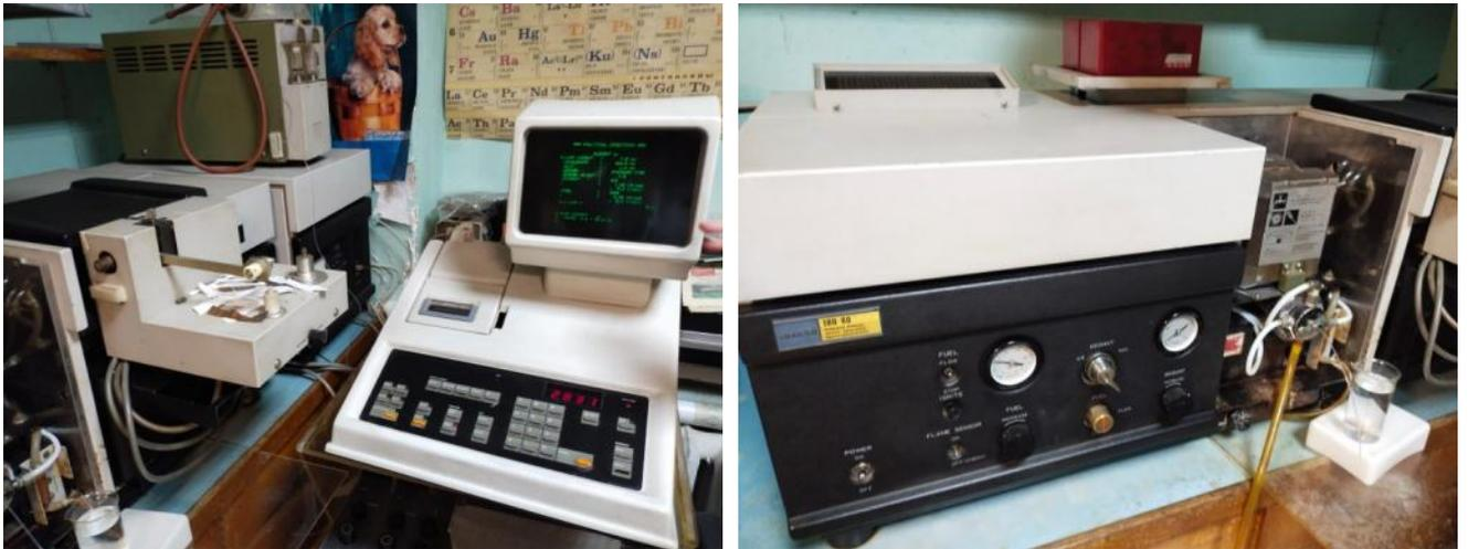
Рисунок 9 – Атомно-адсорбционный спектрофотометр с зеемановской поляризацией Hitachi 180-80
