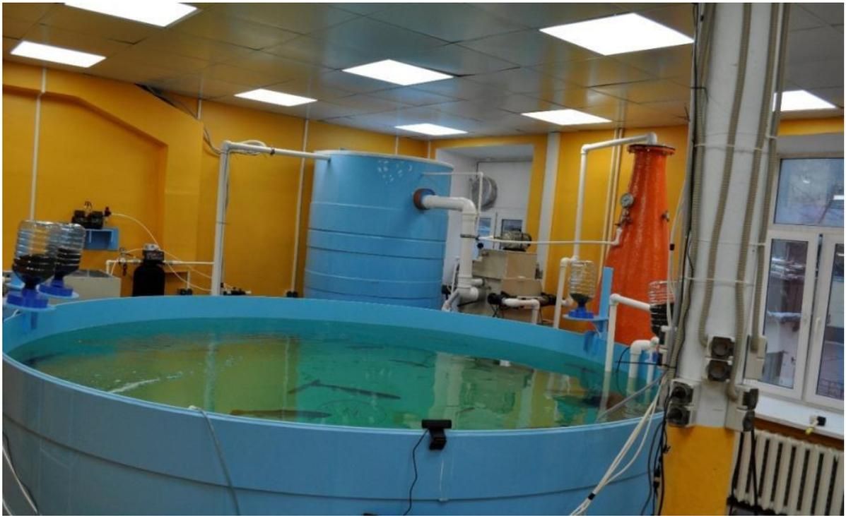
Рисунок 5 – Рыбоводный модуль «Универсального мультипрофильного стенда аквабиотехнологий» УНУ, в котором проходила подготовка форели в эксперимент
