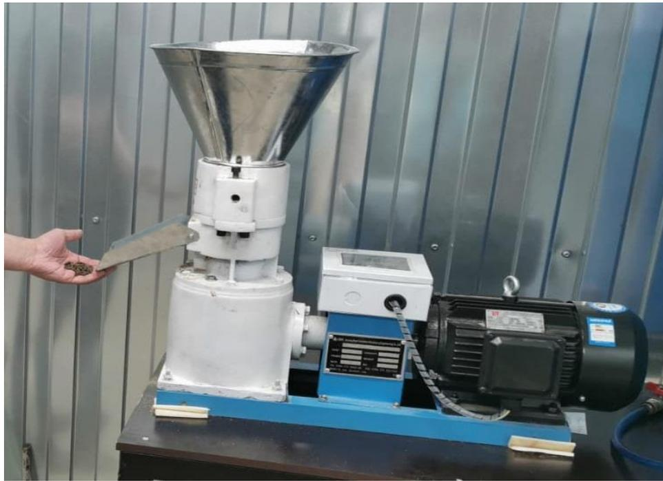
Рисунок 8 – Двухвалковый гранулятор «ZLSP-120»
