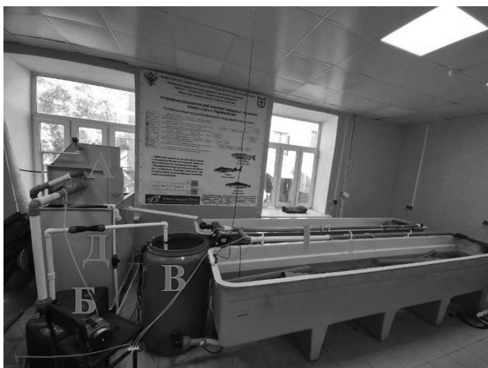
Рис. 4. Работающая система УЗВ для содержания ракообразных с системой терморегуляции (А — фильтр механической
