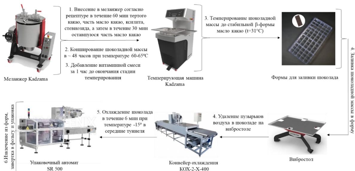
Рисунок 4.1 – Общая схема производства горького шоколада
