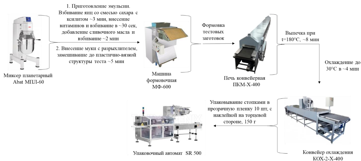
Рисунок 4.5 – Общая схема производства сахарного печенья
